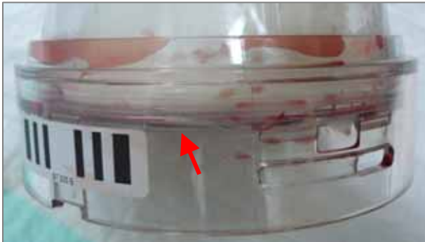
図1. ボウル下部亀裂の実例
